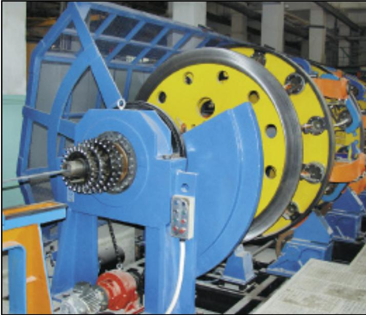
Планетарная бронировочная машина фирмы «Proton» типа PS 500/24. Предназначена для наложения круглопроволочной брони на сердечник оптического кабеля. Количество проволок – 24, диаметр проволок от 0,8 до 3,5 мм. Наличие преформатора в составе машины позволяет равномерно накладывать проволоки на кабель без образования зазоров между ними.
