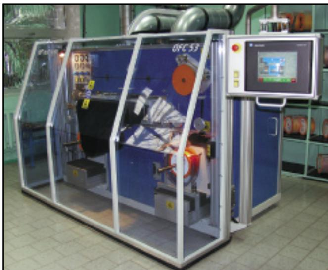
Линия изготовления оптического модуля типа OFC 40. Позволяет изготавливать оптические модули различных диаметров с количеством волокон от 2 до 12 со скоростью до 300 м/мин. Имеет возможность изготавливать окрашенные оптические модули. Линия оснащена устройствами для поддержания постоянства избыточной длины волокон в оптическом модуле, а также лазерным измерителем диаметра и детектором обнаружения неровности поверхности оптического модуля.
