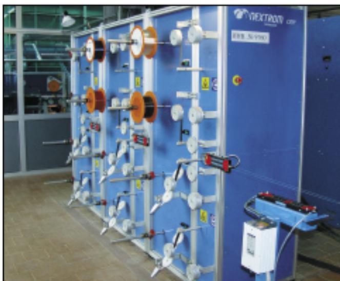
Линия SZ-скрутки оптических модулей типа OFC 70. Позволяет скручивать сердечники оптических кабелей различных диаметров с числом модулей до 12, а также изготавливать кабели как с гидрофобным заполнением сердечника, так и т.н. «сухие» кабели. Линия характеризуется высокой скоростью и стабильностью параметров скрутки кабелей (короткий переходной участок).
