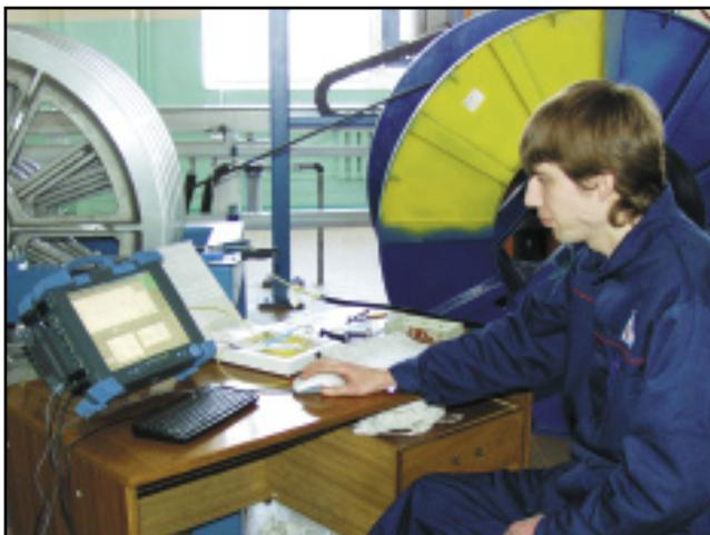
Установка для измерения затухания оптического волокна.
